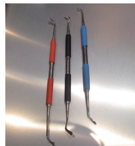
細い隙間や溝にフィルムを貼るための「レーザーチップ」。
