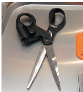
フィルムを真っ直ぐに切るために、持ち手の部分からレーザーが照射される「レーザーシザーズ」。
