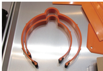
ワンタッチでフィルムを留められる「スピードクリップ」。テープで留める場合と比較して、1年で5日ぶんの時間短縮になる！
