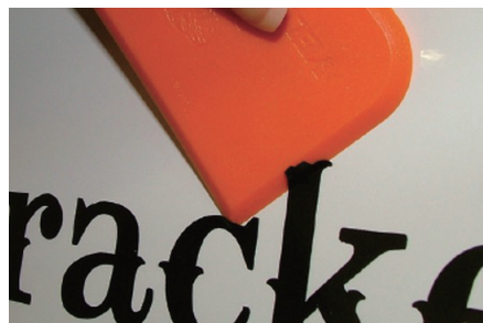
「イエローブレード」は、下地を傷つける心配がない樹脂製のスクレイパー。
